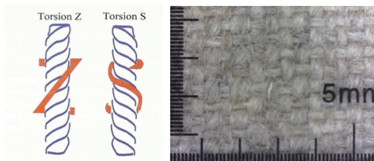
Annexe 23. Schéma des deux types de torsion des fils (©Rostain, Comportement mécanique des peintures sur toiles ).
