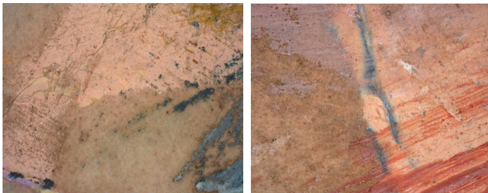
Illustration 92. Détail des « taches » d'origines indéterminées sur une zone ayant été sous protection de surface (gauche) et une ne l'ayant pas été (droite) prise sous microscope USB (x 55)
