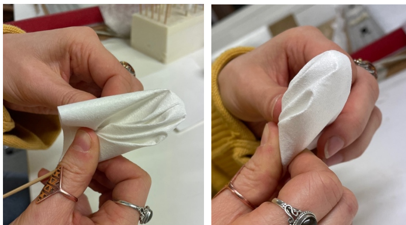
Illustration 12. Détail du pliage de l'Evolon®.
