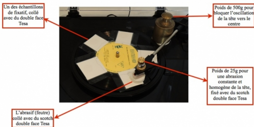
Schéma 8. Mise en place du protocole expérimental du tourne-disque (Crédit : Anne Laure Gautier). Dans, Anne Laure Gautier. Étude comparative de la résistance à l'abrasion de trois fixatifs utilisés comme consolidant de techniques graphiques. CeROArt, URL: http://journals.openedition.org/ceroart/4834 [Consulté le 13/05/21].
